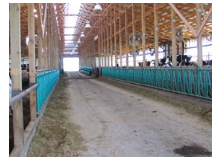
De compoststal lijkt op het eerste gezicht op een ligboxenstal. Er is een voergang, er zijn voerhekken en de stal is overdekt.
