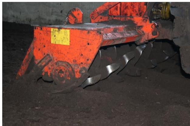
Der Kompost wird zweimal täglich mit der Fräse bearbeitet.
